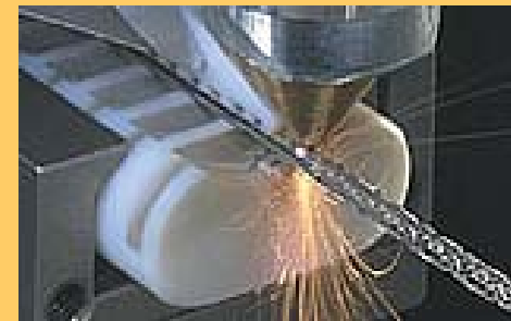
Stent cutting, Kerf width >20 microns
